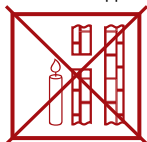
нет тяги (Не используйте котел!)
